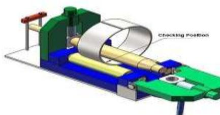
**Figure 5 : Rolling Plate Method**
