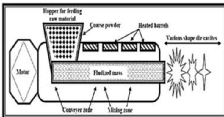
**Figure 4 : Solid dispersion extrusion**
