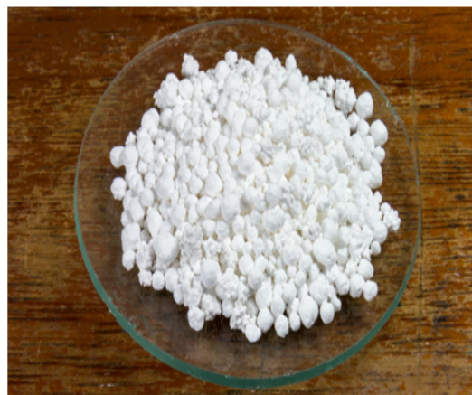
Fig h. Calcium chloride
