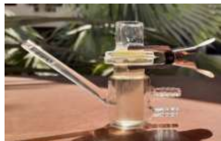
Figure 7 In-Vitro Diffusion using Franz diffusion cell
